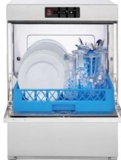
Lavavajillas industrial de cúpula (capota) diseñado para el lavado intensivo y la higienización de vajilla en entornos de alta exigencia. Permite trabajar cómodamente gracias a su carga superior/frontal y su altura útil, procesando cestas de 500x500 mm con una producción de hasta 60 cestas por hora, garantizando resultados óptimos y desinfección.
