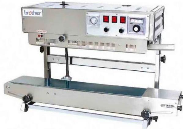
Máquina para el sellado de bolsas de forma continua en posición vertical por medio de una banda transportadora.
