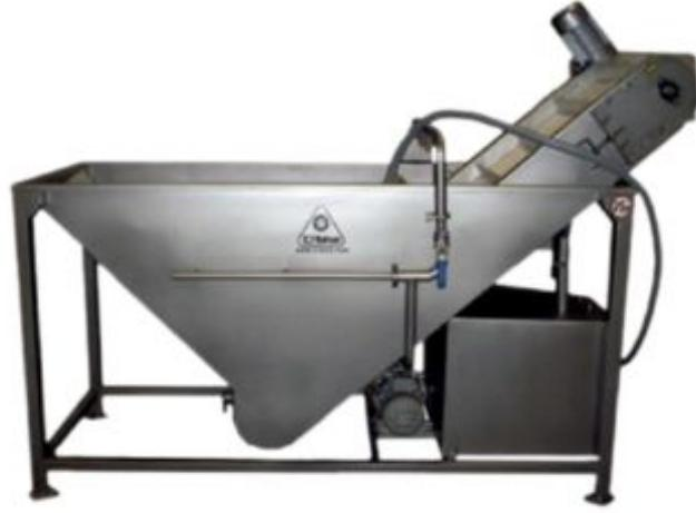
Se utiliza para lavar frutas y hortalizas de hasta 10 cm. Utilizando para ello un tanque de inmersión con turbulencia y una ducha de aspersión plana para terminar el lavado superficial del producto.
